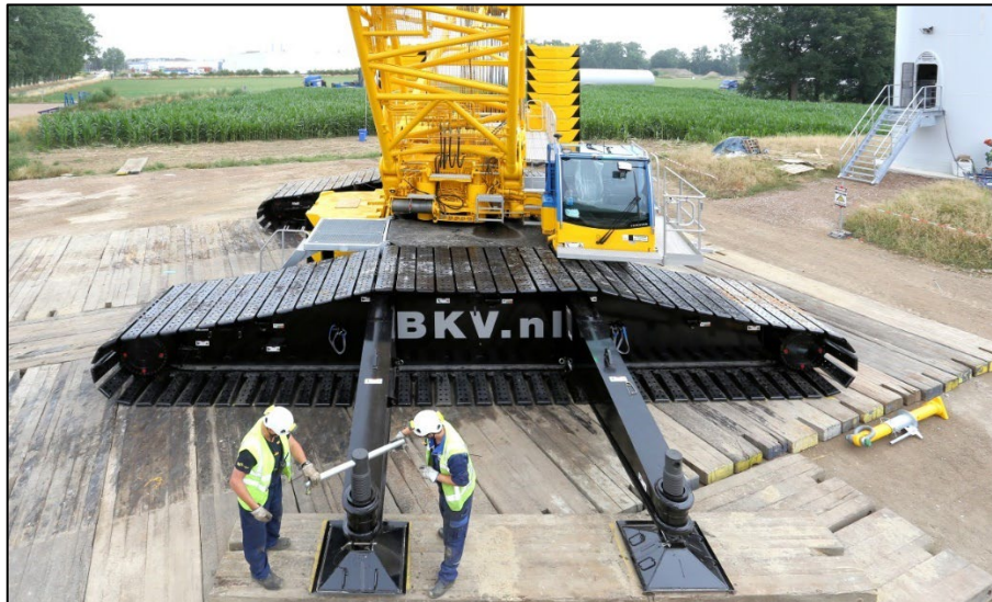
Afbeelding 6 De oprichtsteunen van een Liebherr LR 1600/2 (foto: BKV)
