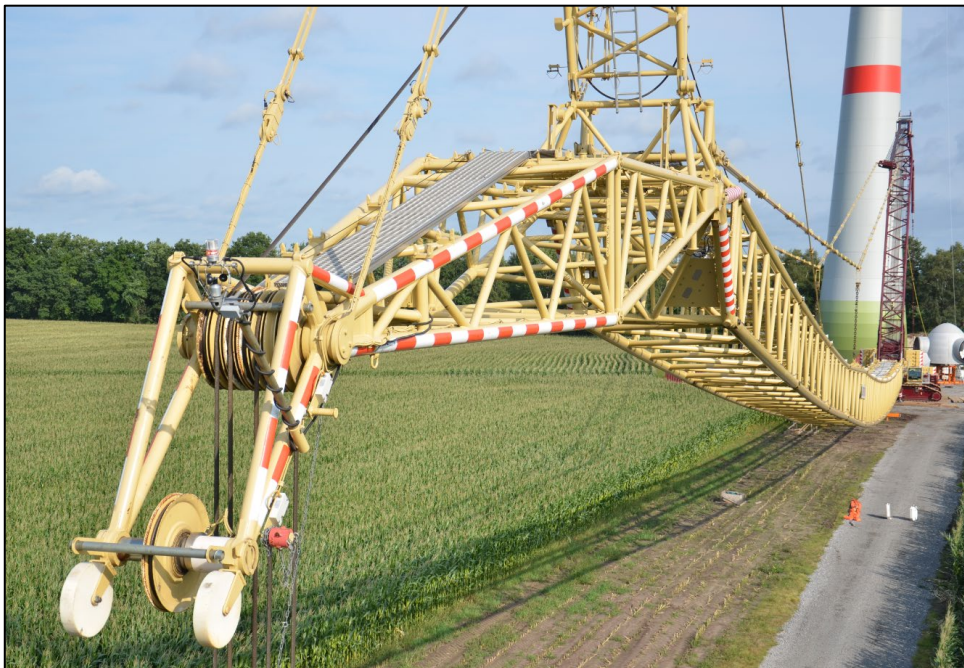
Afbeelding 15 Het oprichten van de giek van een Demag CC 3800-1 (foto: G. Seinen)
