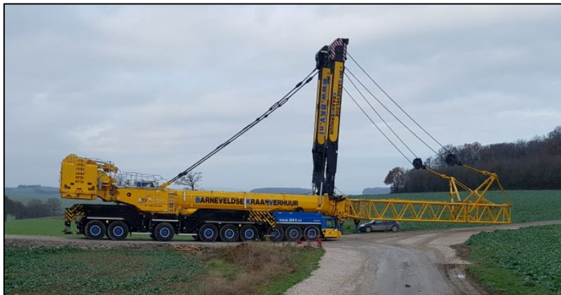
Afbeelding 11 Het transport van een Liebherr LTM1750-9.1 in deels opgebouwde toestand (foto: BKV)
