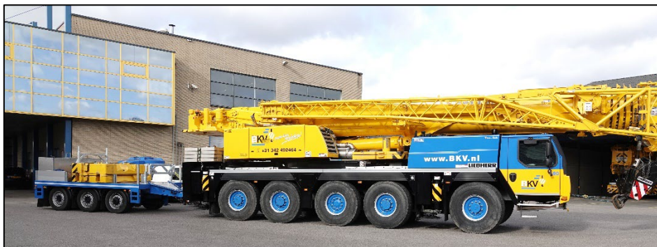
Afbeelding 12 Een drie-assige wipkar achter een telescoopkraan (foto: BKV)
