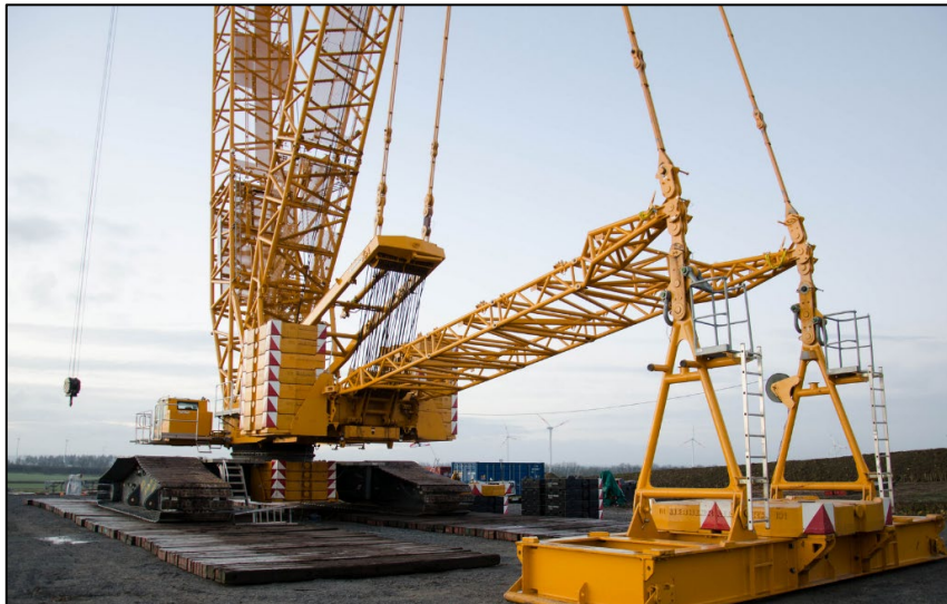
Afbeelding 5 De superlift tray van een Liebherr LR 1600/2 (foto: G. Seinen)
